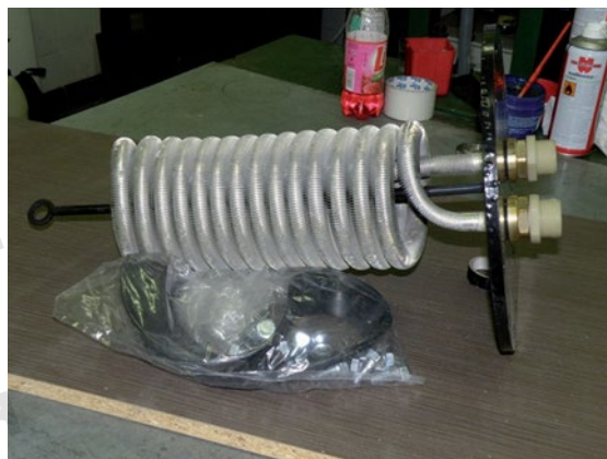
A réz hőcserélő szigetelt elválasztása az előremenő és visszatérő csövektől
