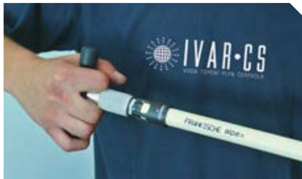
Sorjáltlanítás, cső profil kiigazítása - óramutató járásának irányába.
