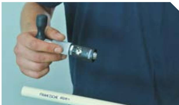
Sorjázó behelyezése az univerzális tartóba, 16-32 mm átmérőig.
